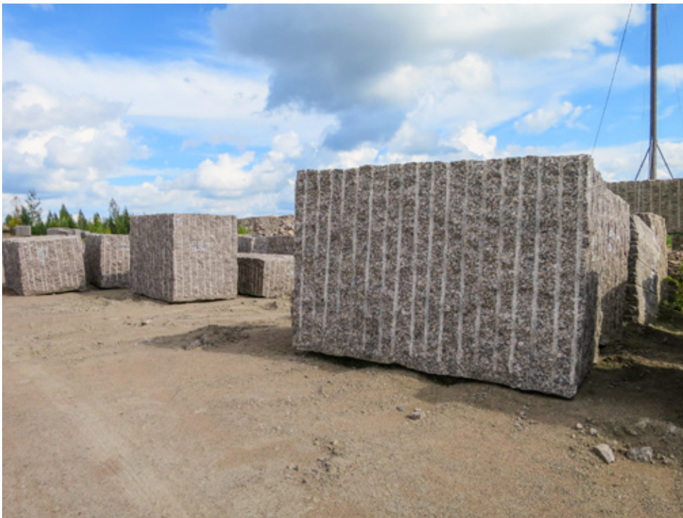
Kuva 2. Luonnonkivituotteen raaka-aine voi olla määrämittainen ja -muotoinen kiviblokki. Kuva: Olavi Selonen.
