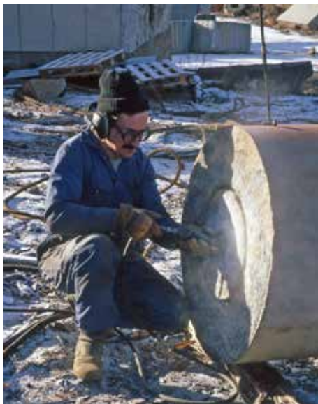
Figur 21. Innan den omvända stenen lyftes tillbaka till valstornet, borrades ett hål i den nedre delen av valsens, vilket centrerade valsens vid sågningen. Foto: Arto Peltola.
