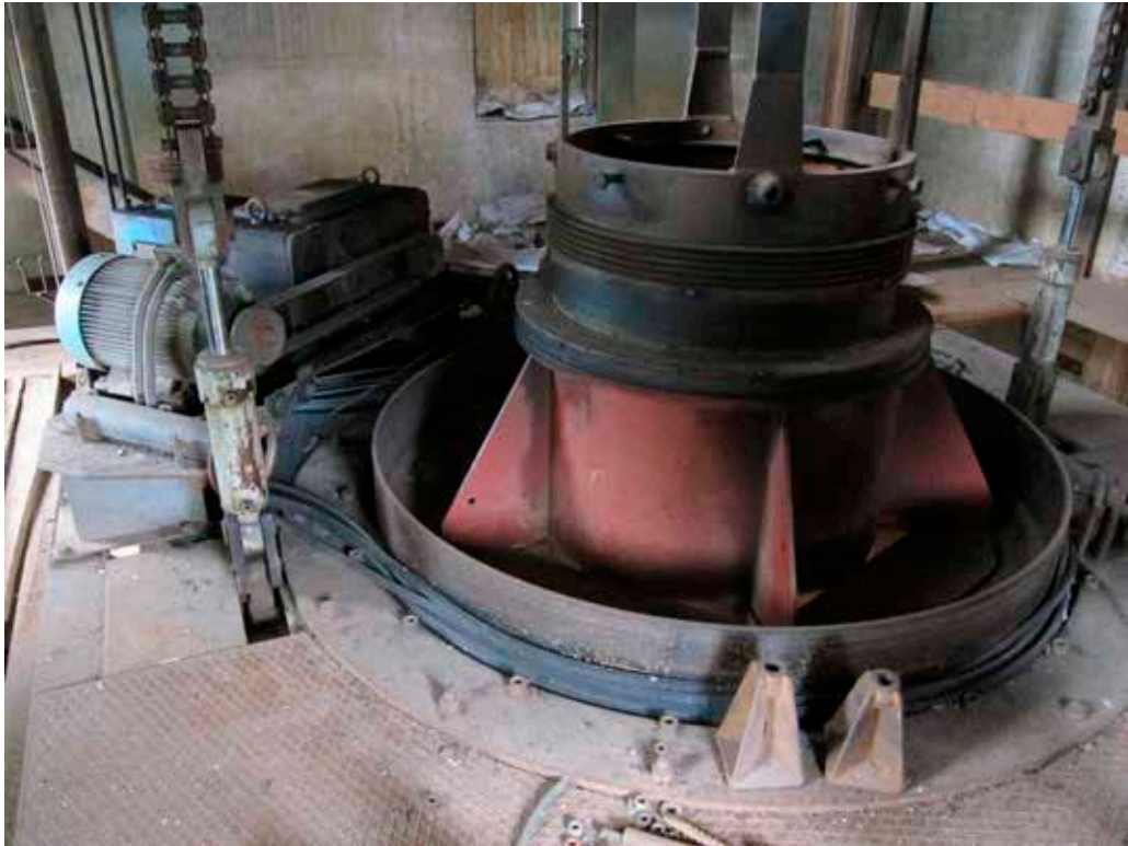
Figur 15. Roteringsmekanismen för cylindersågen. Foto: Paavo Härmä.
