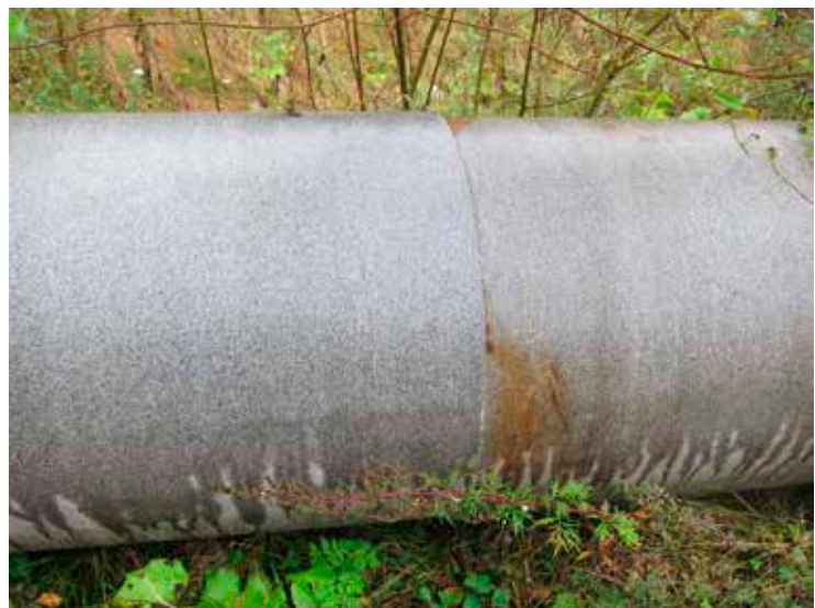
Figur 22. Att döma av en kvarstående stenmantel, har axelsågningen lyckats väl. Sågningen fick missa borrhålet från andra sidan med högst en halv centimeter i mitten av valsens. Foto: Paavo Härmä.
