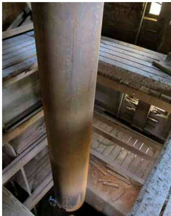
Figur 16. Cylindersågen var gjord av ett stålrör med skåror i borrhstycket. Foto: Paavo Härmä.
