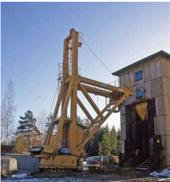
Figur 13. Stenen lyftes upp till valstornet för sågning i vertikalt läge. Foto: Arto Peltola.
