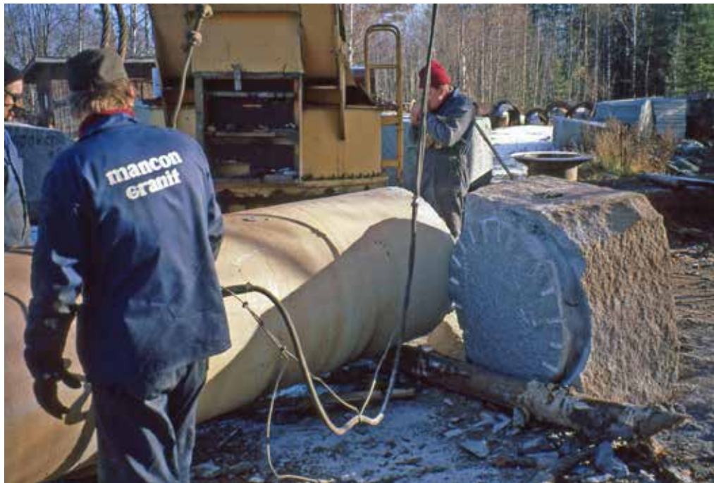
Figur 20. Styckningen av valsens botten lyckades väl. Så var inte alltid fallet, därför inräknades en säkerhetsmarginal på 60 cm på valsens längd. Foto: Arto Peltola.
