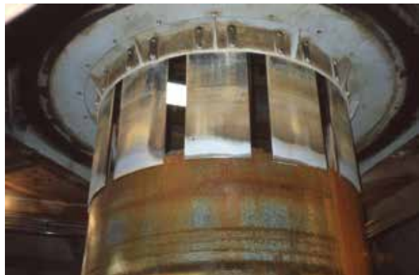
Figur 14. Den yttre ytan av valsen sågades med en roterande cylindersåg. Foto: Roger Aapola.
