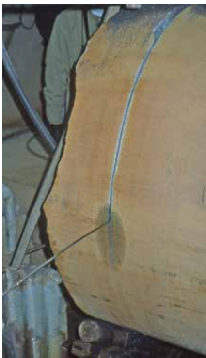
Figur 23. Styckning av valsämnet till lämplig längd med hjälp av vadersåg. Foto: Roger Aapola.
