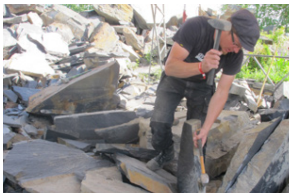
Kuva 13. Liuskekiviaihiot lohkotaan liuskelevyiksi taltalla ja vasaralla. Kuva: Seppo Leinonen, GTK.
