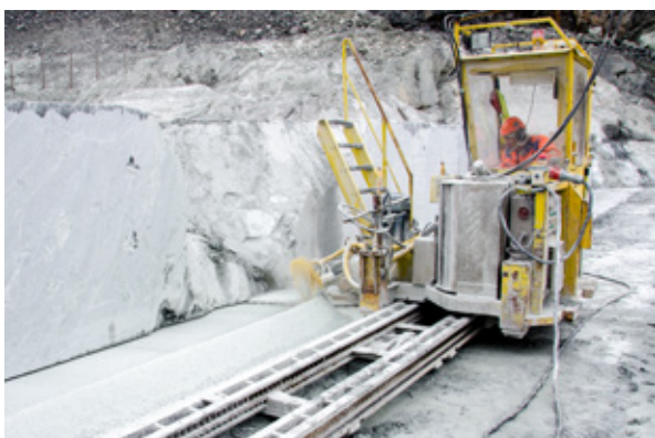
Kuva 12. Vuolukiven vaakasahausta. Kuva: Esko Koistinen, GTK.
