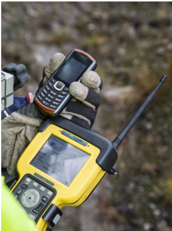
Kuva 3. Tutkimusurien kartoituksessa voidaan käyttää tarkkuus-GPS -laitteita. Kuva: GTK.
