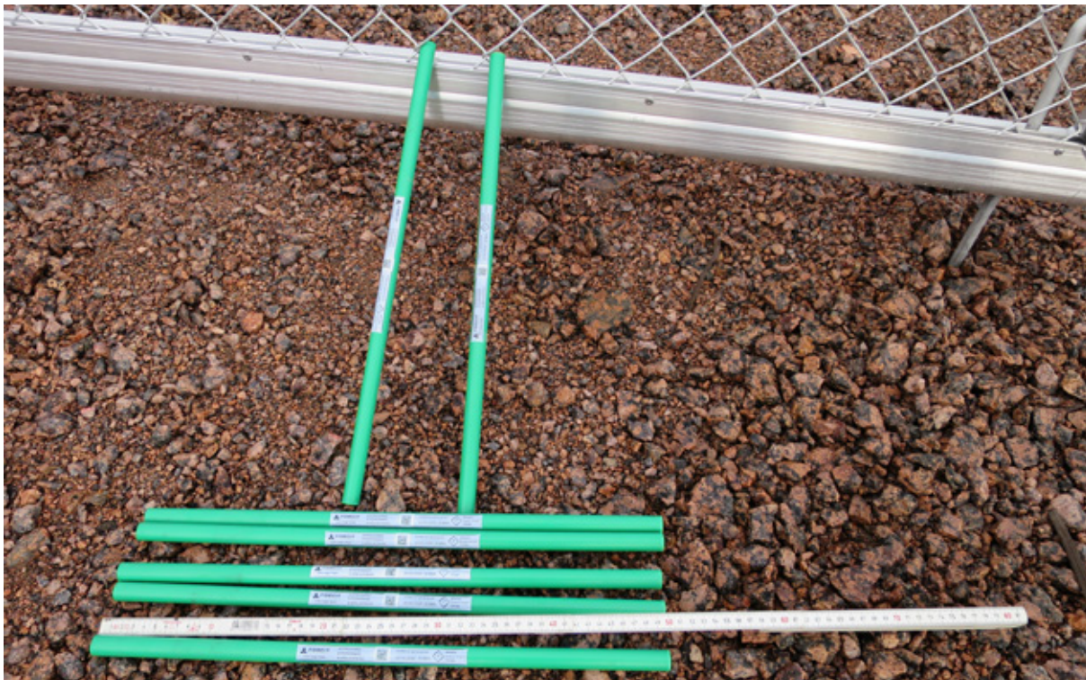
Kuva 10. Graniitin louhinnassa käytetään putkipanoksia. Kuva: Olavi Selonen.
