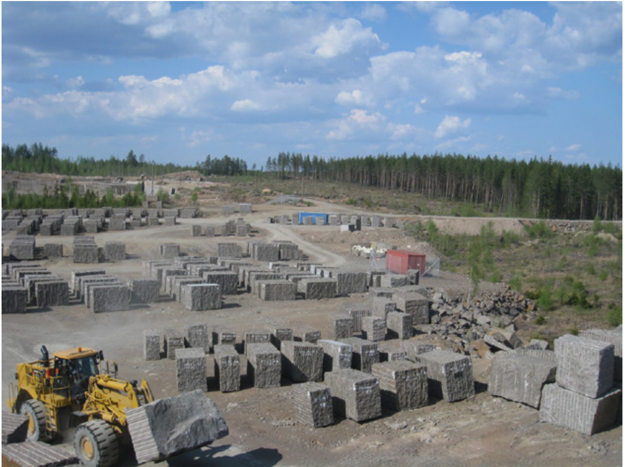
Kuva 9. Graniittilouhimon tuote on määrämuotoinen ja -mittainen, laatuluokiteltu kiviblokki. Kiviblokit varastoidaan omalle varastoalueelleen louhimolla. Kuva: Pauli Salmela.
