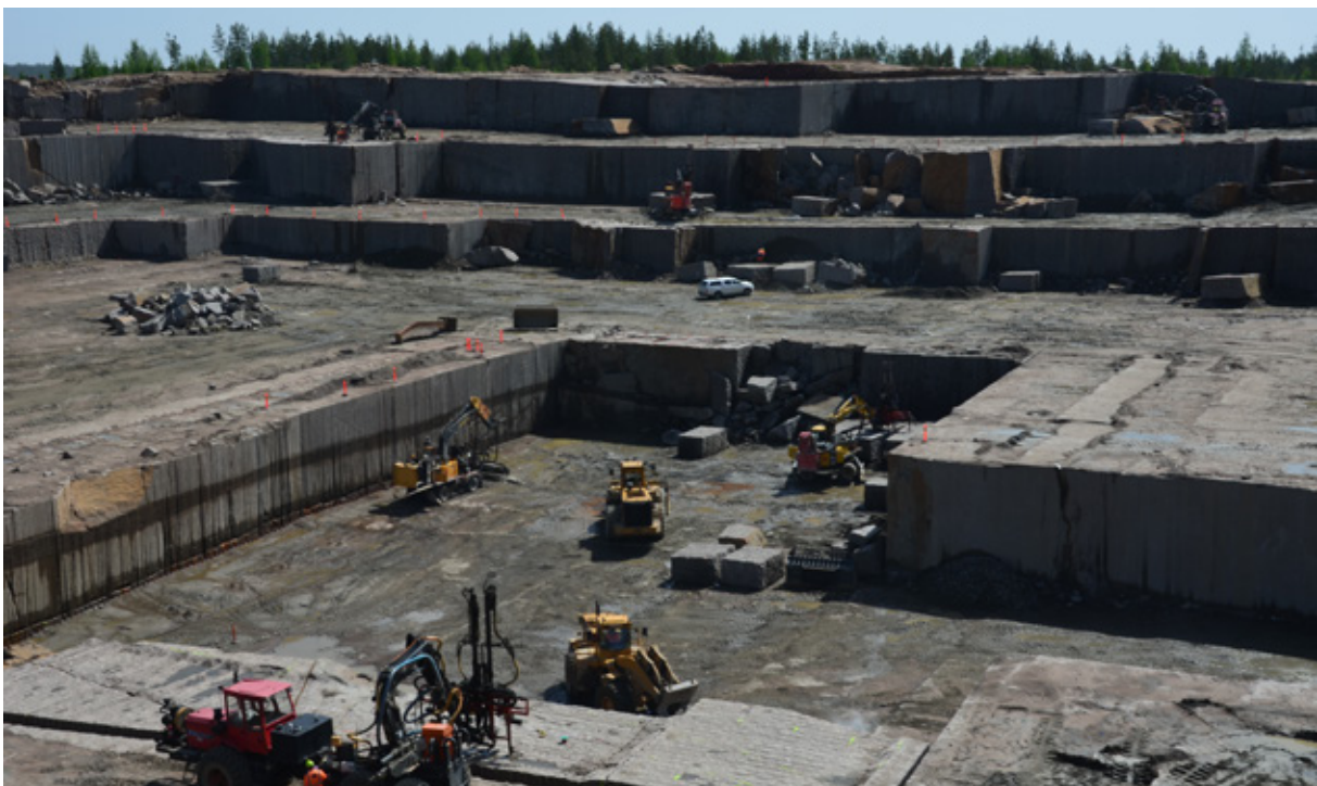
Kuva 8. Tyypillistä graniitin louhintaa. Kami on irrotettu (etualalla) ja paloitteluporaus on käynnissä. Kuva: Mika Räisänen, GTK.
