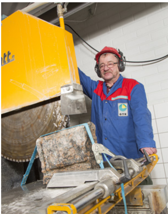
Kuva 5. Minikairanäytteet halkaistaan ja kiillotetaan, lohkarinäytteistä voidaan valmistaa määrämittäisiä testilohkareita tai kiillotettuja levyjä. Kuva: GTK.
