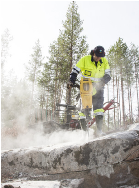
Kuva 4. Lohkarenäytteen irrottaminen kiilaamalla. Kuva: GTK.
