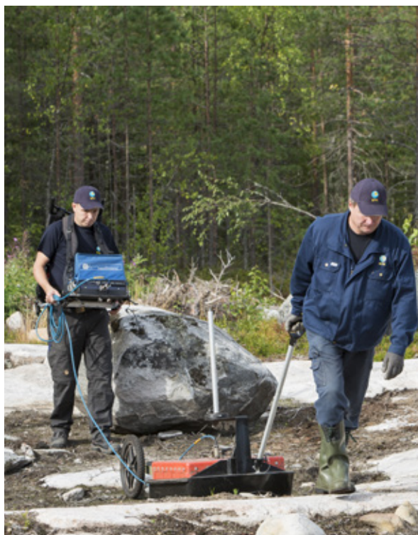
Kuva 6. Vaaka- ja vinorakoilun määrää kallioperässä voidaan selvittää maatutkaamalla paljastetuilta kallio-pinnoilta tai ohuiden maapeitteiden läpi. Kuva: GTK.
