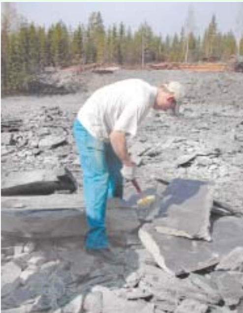
Liuskekivi irrotetaan kaivinkoneella. Liuskekivilaatat lohkotaan käsityönä.
